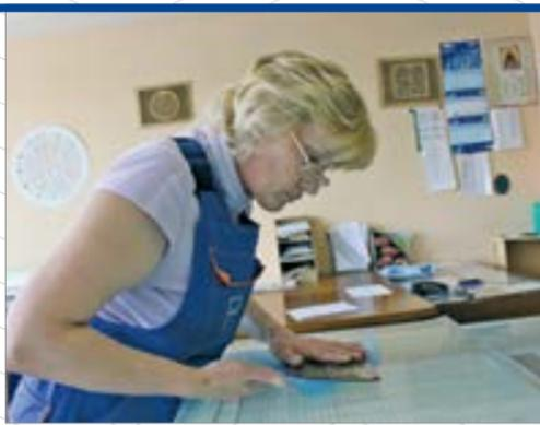
Вторая производственная площадка. Участок подготовки производства. Монтаж клише.
